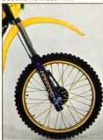
Fourche avant hydraulique à air. Débattement 280 mm.
