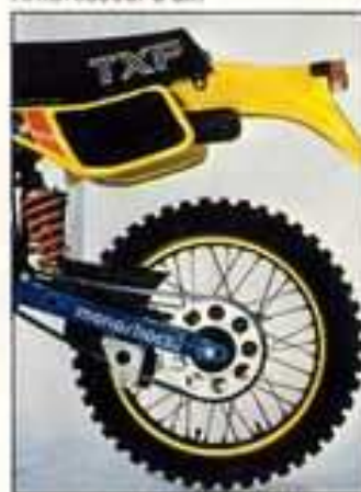
Suspension AR monoshock. Débattement 280 mm. Amortisseur à air.
